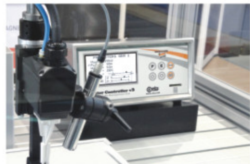
鐳射定位紅外線測溫儀 Optical Sensor
