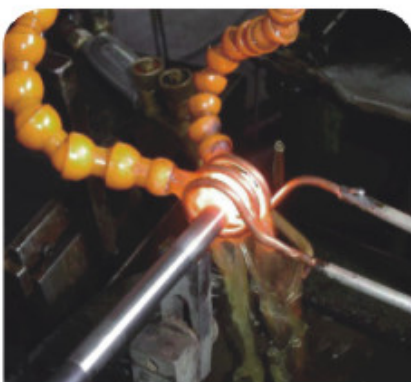
引擎汽門硬化 Engine valve hardening
